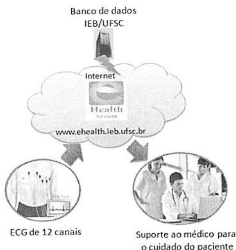
Fig. 1 - Estrutura do projeto. O equipamento de ECG de 12 canais (localizado remoto) onde os sinais são adquiridos e enviados para o servidor via web. O servidor, localizado fisicamente no IEB-UFSC, onde serão processados e analisados os dados. Esta página da web fornece a análise do diagnóstico dos níveis de neuropatia autonômica (inexistente, subclínica e clínica)
